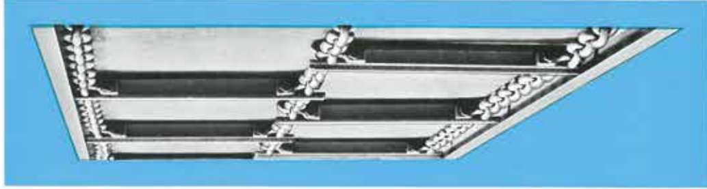
Potójny przenośnik zgrzeblowy z łańcuchem ze stali okrągłej i zgrzeblami profilowymi
